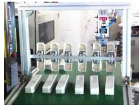
Kalıp Dışı Soğutma outside cooling
